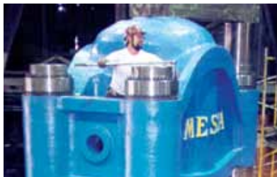
Установка восьми гаек Superbolt для колонн заняла всего 12 человеко-часов в отличие от двух с половиной дней, требовавшихся для нагрева колонн.
