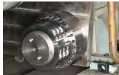
Упорно-разрезные гайки, специально разработанные в серии продукции Superbolt, значительно проще устанавливать и снимать по сравнению с большими резьбовыми крепежными деталями на крупных колоннах прессов.
