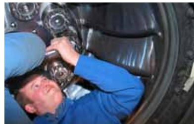
Устройства натяжения Superbolt позволяют проводить монтаж болтовых соединений даже в самых неудобных положениях и в ограниченных пространствах. Соединение рабочего колеса турбины с валом с применением устройства MJT позволило удовлетворить требования по регулярному техническому обслуживанию рабочего колеса.
