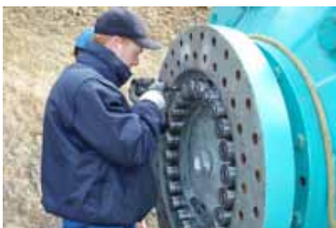
Фланцевое соединение редуктора ветровой турбины. Для передачи чрезвычайно высокого крутящего момента используется распорный болт с технологией Superbolt. Такая конструкция имеет небольшие размеры и массу в соответствии с требованиями заказчика.
