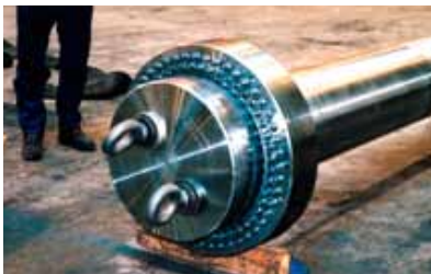
Крупнейшая в мире система мульти-натяжителей болтового типа диаметром 28 дюймов и длиной 40 футов (диаметром 711,2 мм и длиной 12,2 м) использована на большом гидравлическом ковочном прессе.
