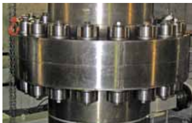
Распорные болты Superbolt прекрасно подходят для соединений валов, как показано на снимке соединения вала радиально-осевого насоса с валом генератора наливного резервуара для жидкости.
