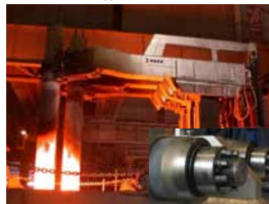
Электрододержатели дуговой печи. С помощью устройства MJT удалось добиться высокой силы зажима, чтобы выдерживать сильную вибрацию, воздействующую на рычаг электрода.
