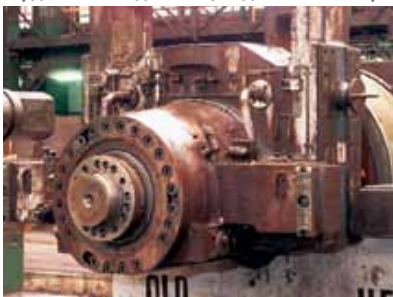
Упорные кольца на подушках для подшипника создают увеличенный предварительный натяг, по сравнению с предыдущим методом, и позволяют поглощать самые высокие пиковые нагрузки. Это увеличивает срок службы шеек прокатных валков и обеспечивает бесперебойную работу завода.
