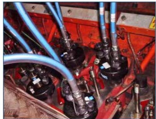
Специальное устройство для затяжки болтов головки газового двигателя
